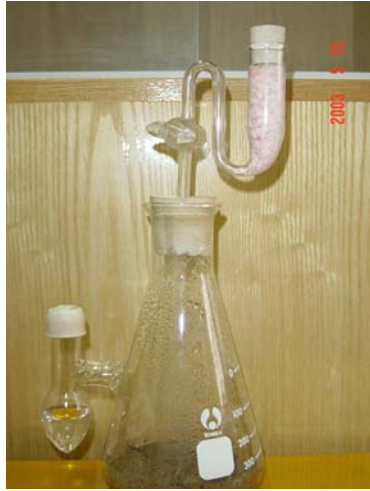
图 7. 土壤样本进行实验室培养, 将土壤总碳量分为快、中、慢三个库, 用于调整 INTEC 模型参数.
