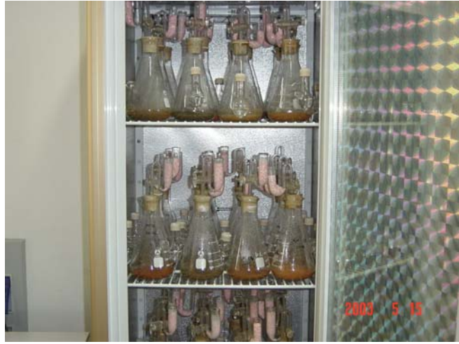
图 7. 土壤样本进行实验室培养, 将土壤总碳量分为快、中、慢三个库, 用于调整 INTEC 模型参数.
